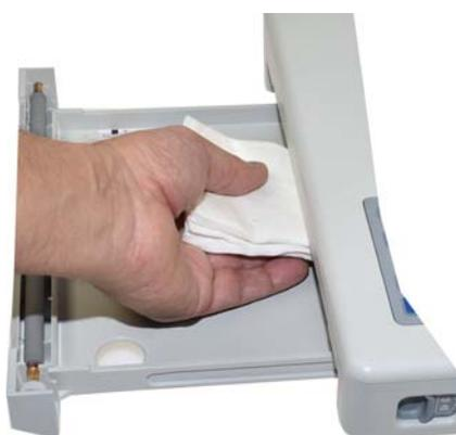
Avec le temps, un résidu d'encre provenant du quadrillage du papier peut s'accumuler sur la tête d'impression thermique et nuire à la qualité d'impression. Il est donc recommandé de nettoyer la tête d'impression tous les mois avec de l'alcool. Pour effectuer cette opération, procéder comme suit :
