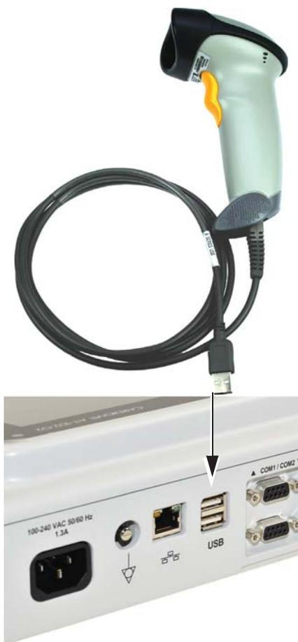
Il est possible de brancher un lecteur de code-barres sur le port à l'arrière de l'appareil pour faciliter la saisie du n° de patient ou du n° de visite. SCHILLER a vérifié le lecteur de code-barres suivants :
