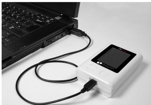
Figure 1-4 : Connexion du OnTrak 90227 à un PC via USB
