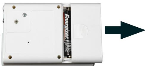
2. Remplacez les batteries en respectant la polarité. La position correcte de la batterie est indiquée à l'intérieur du compartiment des batteries.
